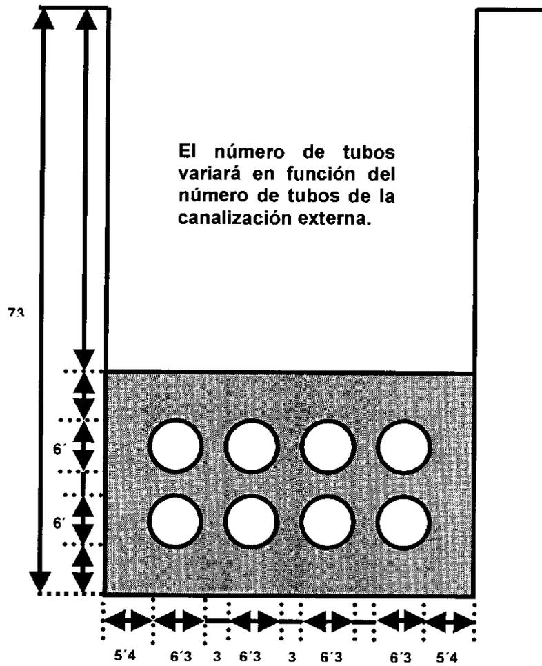
**APÉNDICE 4: EJEMPLO DE SECCIÓN TRANSVERSAL DE CANALIZACIÓN DE ENLACE SUBTERRÁNEA DE 8 TUBOS.**
